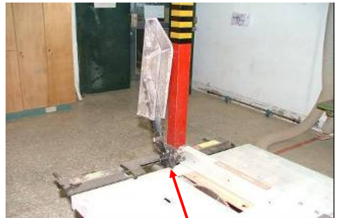
木材加工用圓盤鋸設有鋸齒接觸預防裝置及反撥預防裝置
