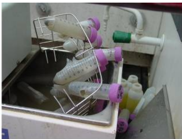
炸裂之實驗用塑膠管
