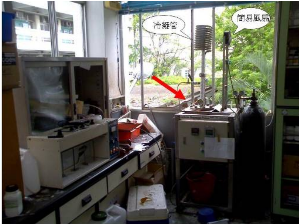
引發本事故之氧化蒸發設備模組 (如箭頭)- 注意: 實驗室窗戶及週遭易碎設備遭波及
