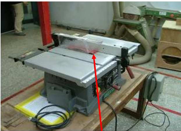
木材加工用圓盤鋸設有鋸齒接觸預防裝置及反撥預防裝置
