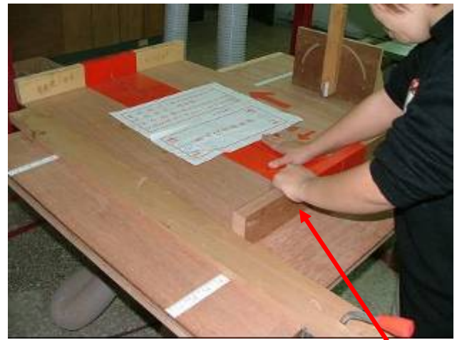
發生事故之圓盤鋸，仿當時學生作業之情形，以右手壓住木材往前推，但未確實使用進料推盤。
