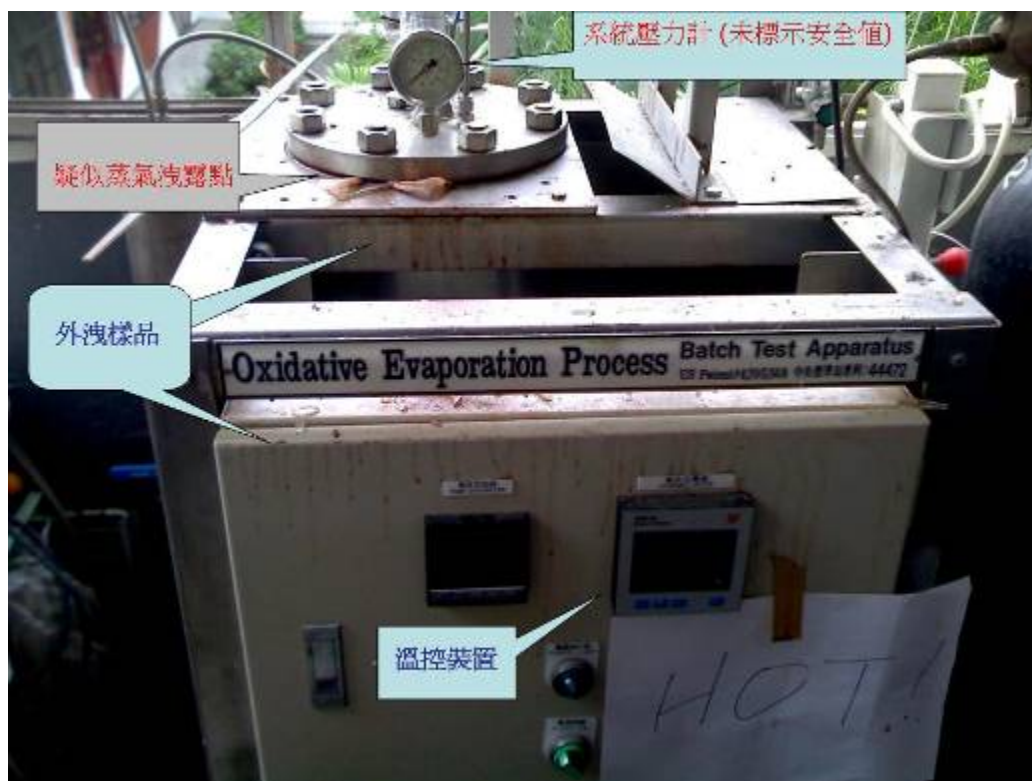
引發本事故之氧化蒸發設備模組 (如箭頭)- 注意: 實驗室窗戶及週遭易碎設備遭波及
