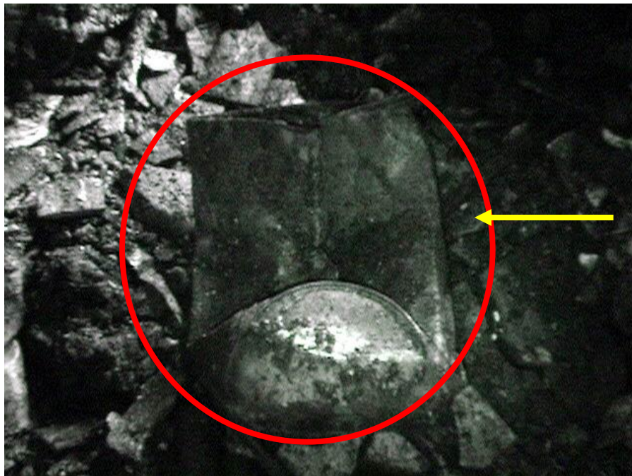
化學藥品外包鐵罐因受撞擊壓縮後導致變形
