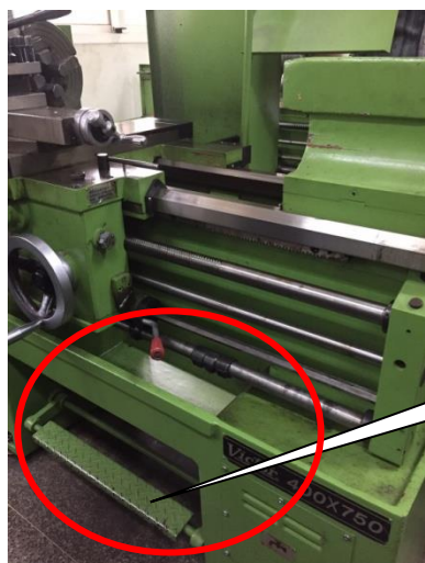
圖 2. 車床緊急煞車踏板
