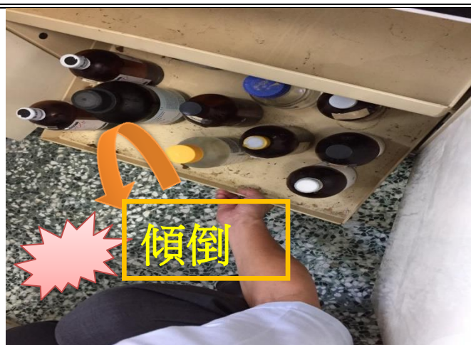
圖 1. 藥品盛盤未設置阻擋裝置，致使過度拉出而導致重心不穩傾倒。
