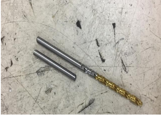
圖 3. 使用之鑽頭及斷裂後殘存於夾頭部分
