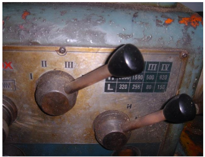
圖 2.車床主軸提供四段變換轉速功能 (廠牌:TAKISAWA ; 編號:L043)
