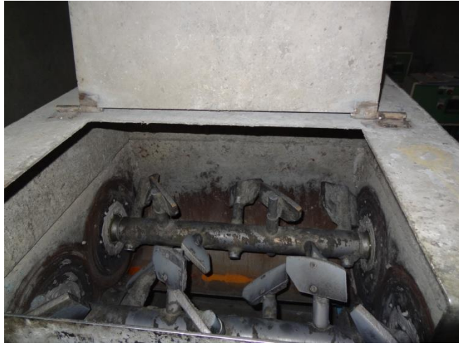
圖 2. 該試驗儀進行混合之機構
