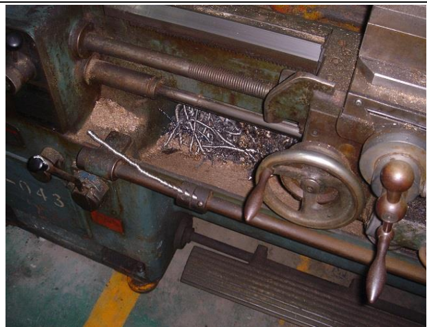
圖 6.滑板箱下方還有車床車削後捲狀鐵屑
