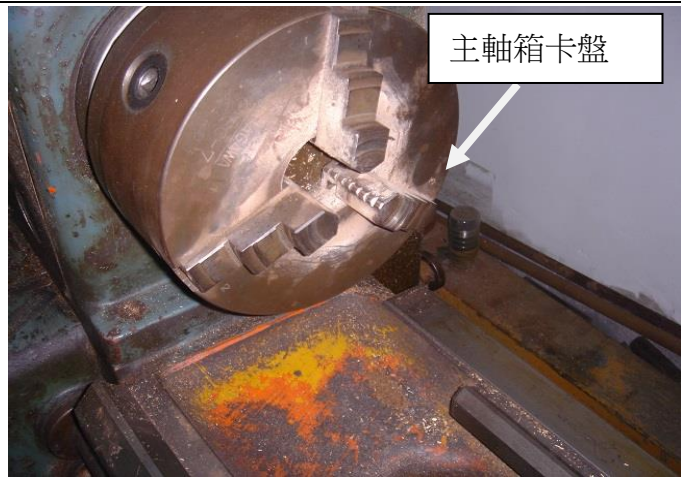
圖 4.車床主軸箱與卡盤
