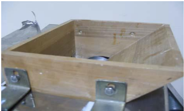
說明：木箱具有阻隔功能(但深度不足)
