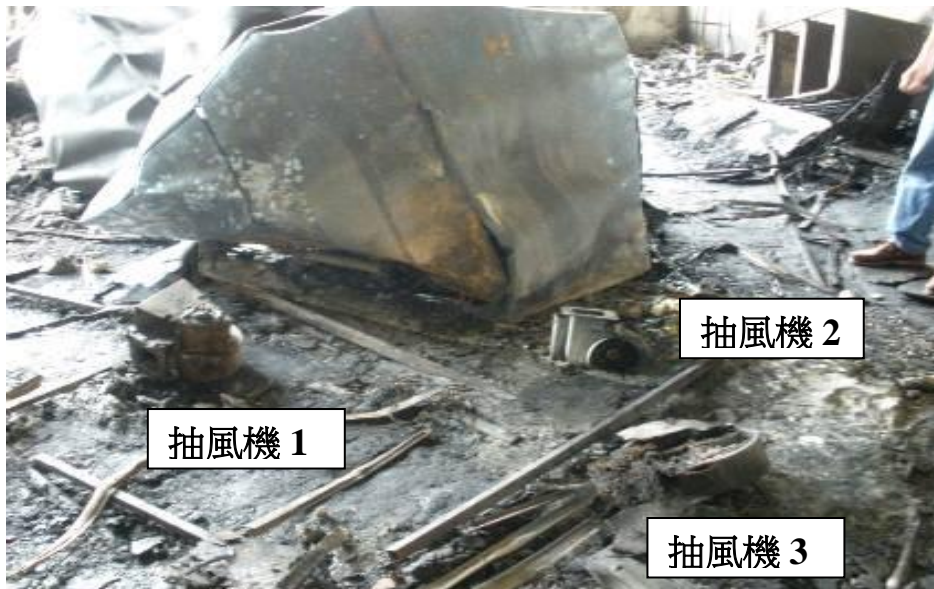
圖四 三個 PP 櫃抽風機散落情形
