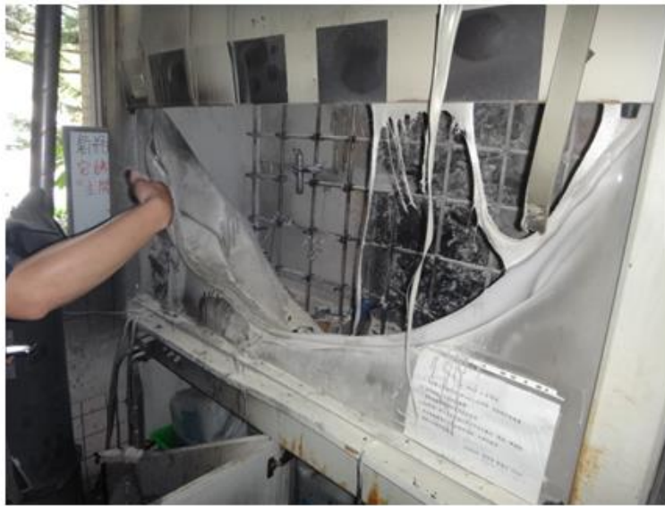
毀損之排煙櫃-壓克力視窗熔毀，局部排煙櫃背板燒焦，上方排氣管前半部毀損
