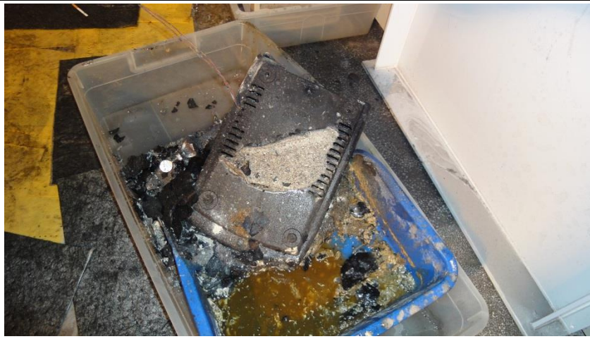
移出毀損陶瓷加熱攪拌器
