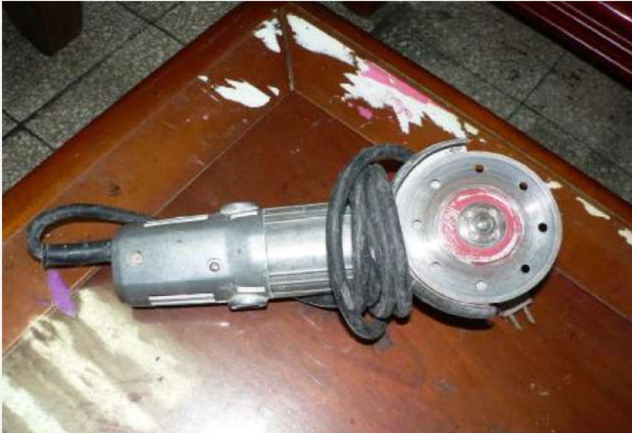
砂輪機漏電發生感電災害
