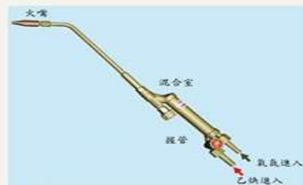
圖7 吹管火嘴構造圖
