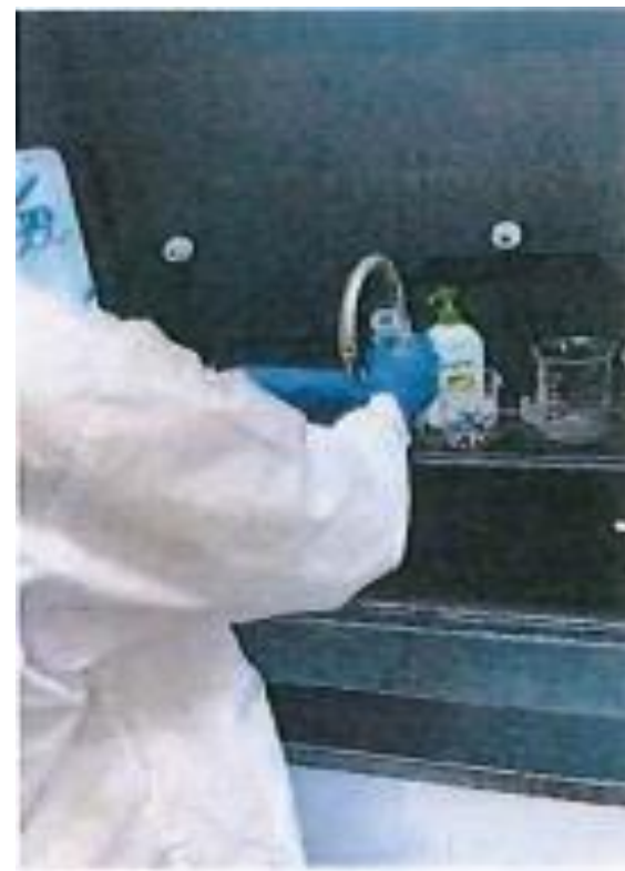
圖5-3：配戴個人防護具時，未將防護手套套緊防護衣袖口。
