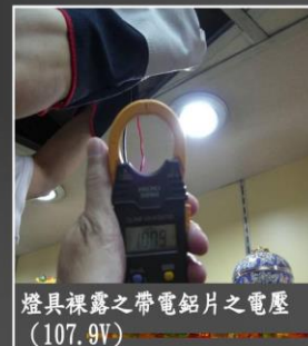
燈具裸露之帶電鋁片之電壓
