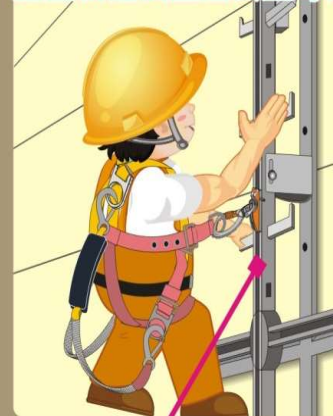
CNS14253-4 附設滑動式擒墜器之 垂直軌道及垂直安全母索
