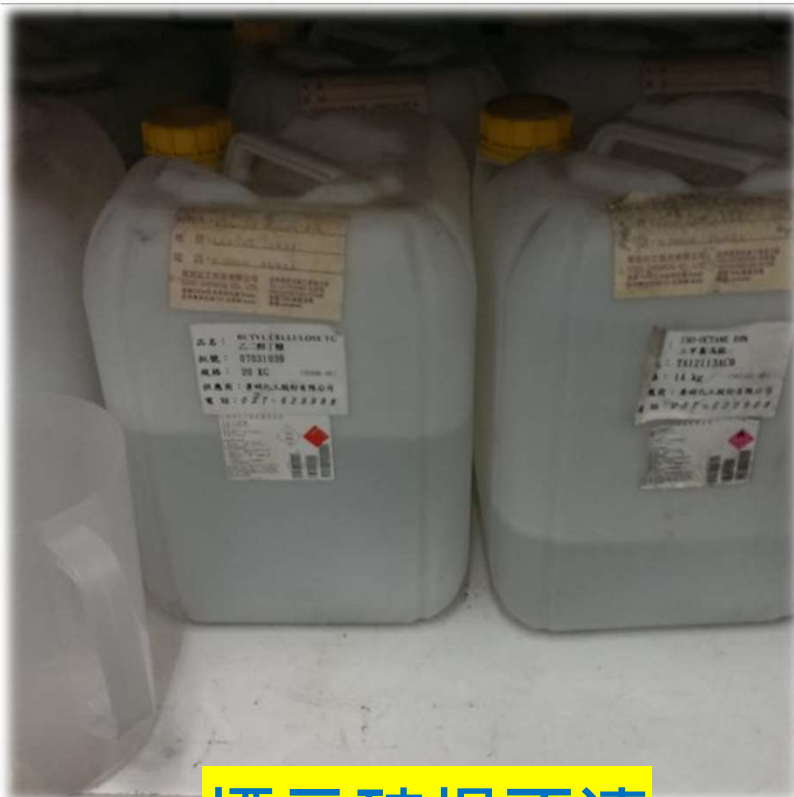
標示破損不清
