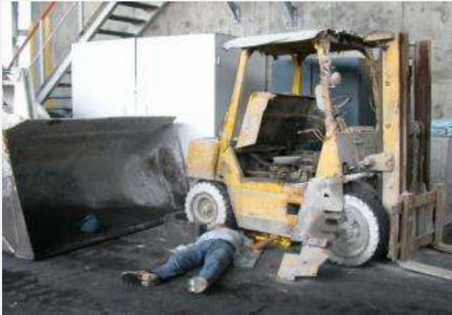
從事堆高機檢查維修作業 發生被壓致死災害
