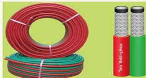
圖5 紅色橡皮管為乙炔用 綠色橡皮管為氧氣用
