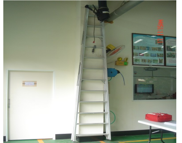
高逾2公尺，未設踢腳止滑裝置
