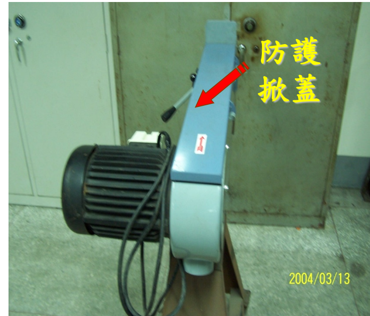
迴轉式砂帶機的傳動防護
