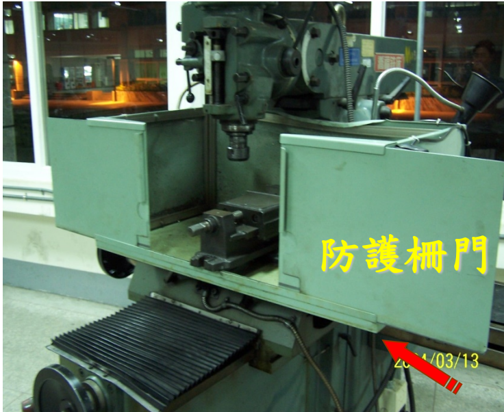
立式銑床的刀軸防護
