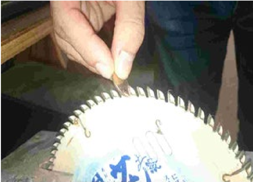
鋸片安裝鋸情形(鋸齒深約0.8公分)
