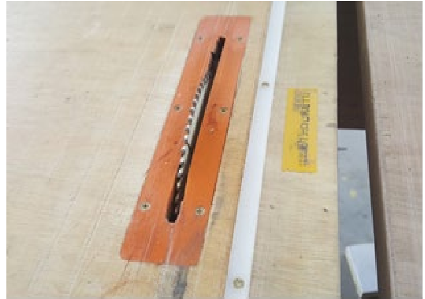
肇事圓盤鋸工作檯面與鋸片 鋸片突出工作檯面約調整在3公分
