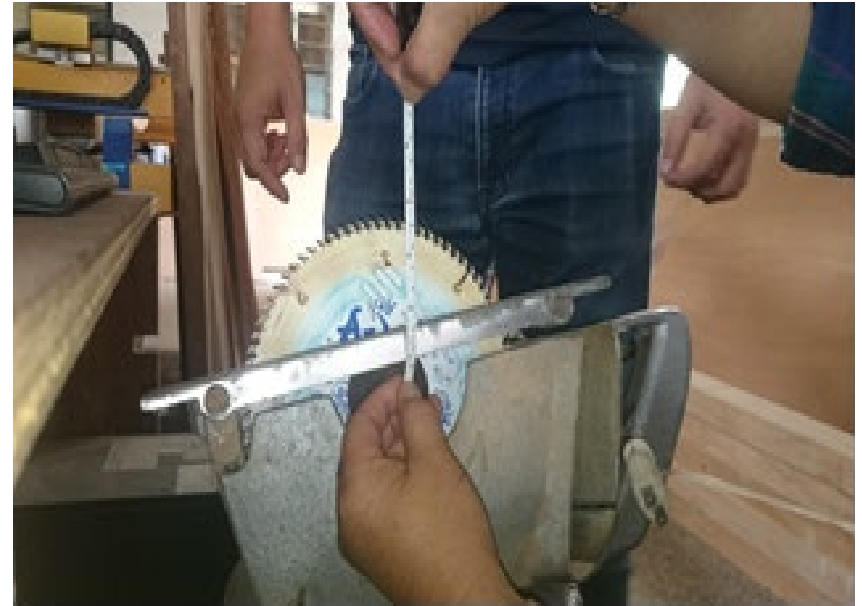
事故時，僅露出鋸齒及裝於鋸切 檯面下方之圓盤鋸(直徑21公分)
