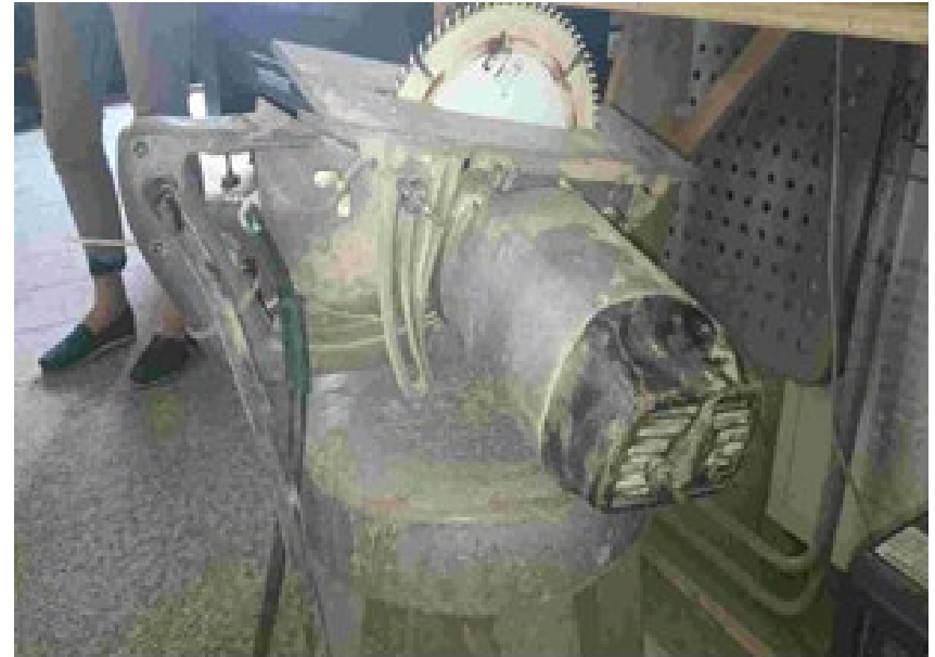
肇事之圓盤鋸，未接接地線且反撥預防安全裝置因反裝於檯面下而無效能
