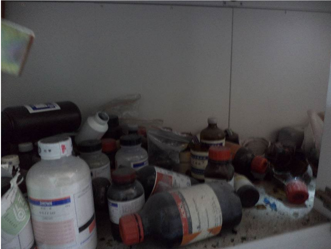
排氣櫃下方因爆炸炸穿導致下方藥品瓶破損
