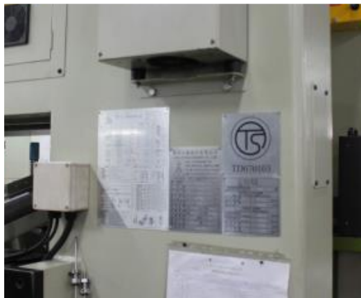
附照2：衝剪機械產製運出廠場或輸入者，是否於勞動部職業安全衛生署機械備器具安全資訊網指定申報登錄網站完成登錄及張貼安全標示。
