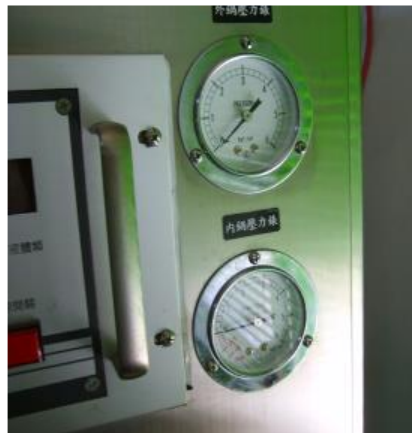
▲高壓滅菌釜設備（小型壓力容器無安全作業標準 SOP 且未實施自動檢查，另未明顯標示最高使用壓力之位置。
