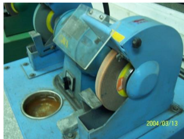
▲桌上用研磨機或床式研磨機，應設有舌板可調整研磨輪與工作物支架之間隙在 3 毫米以下之工作物支架
