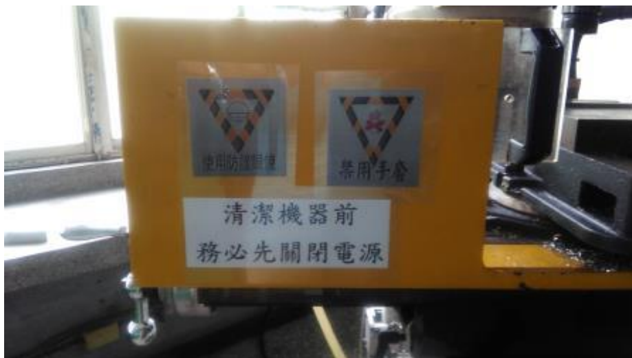
▲機械實習工廠之機械設備調整、維修、清掃時，請關閉電源並採取上鎖及標示。
