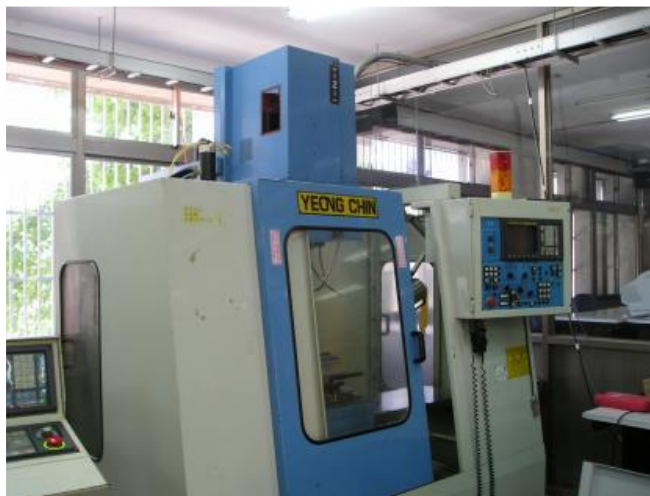
▲CNC銑床未具有連鎖性能之安全門
