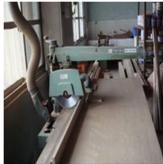
▲木材加工用圓盤鋸應設反撥預防裝置及鋸齒接觸預防裝置
