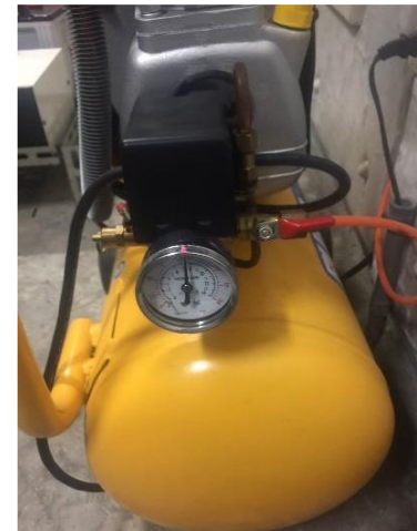
▲空壓機標示最高使用壓力之位置。
