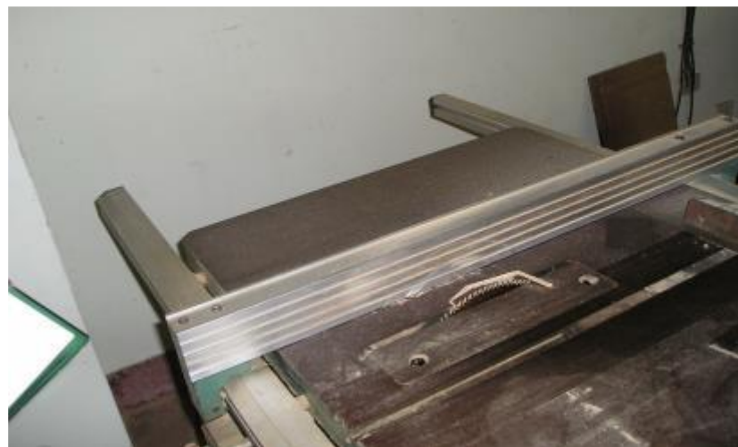
▲木材加工用圓盤鋸未設置護罩或護圍等設備
