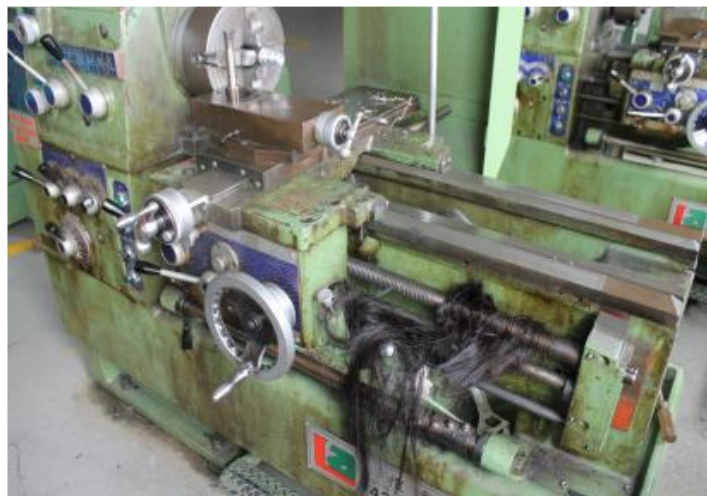
▲操作車床人員未確實著用適當的帽子致頭髮遭導桿捲入
