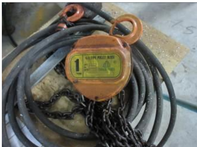
▲鏈吊輪未標示其荷重，且未定期實施檢點並留存紀錄
