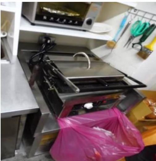
▲餐廳廚房內所使用之高溫爐具如烤爐、蒸爐等未依規定設置高溫警告標誌
