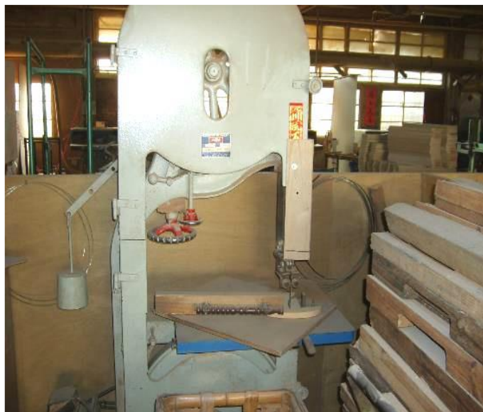
▲木材加工用帶鋸鋸齒(鋸切所需之部分及鋸床除外)及帶輪，應設置護罩或護圍等設備。
