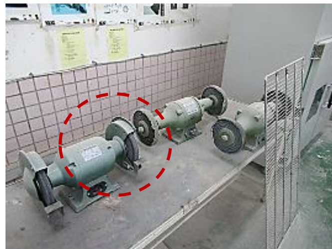
研磨機(砂輪機)護罩與研磨間距不足
