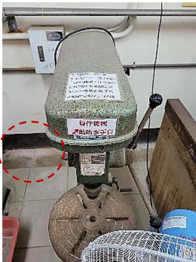
實習工廠內木屑粉塵堆積顯著
