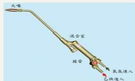
圖7 吹管火嘴構造圖
