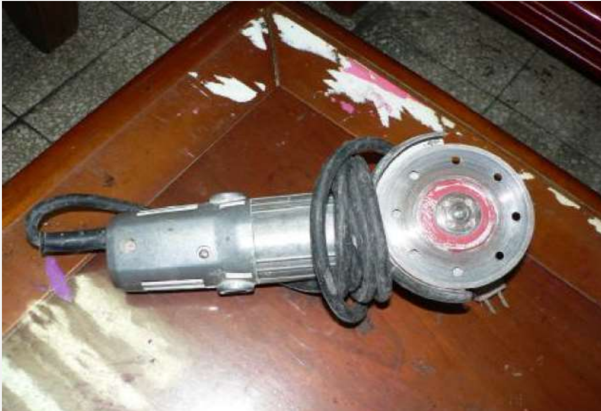
砂輪機漏電發生感電災害
